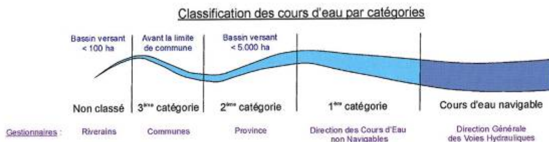
Figure 5 : Classification des cours d'eau par catégories (Source « Les risques majeurs en Région wallonne - Prévenir en aménagement », collection ETUDES ET DOCUMENTS - Série AMENAGEMENT ET URBANISME 7, DGATLP, Namur 2006)
